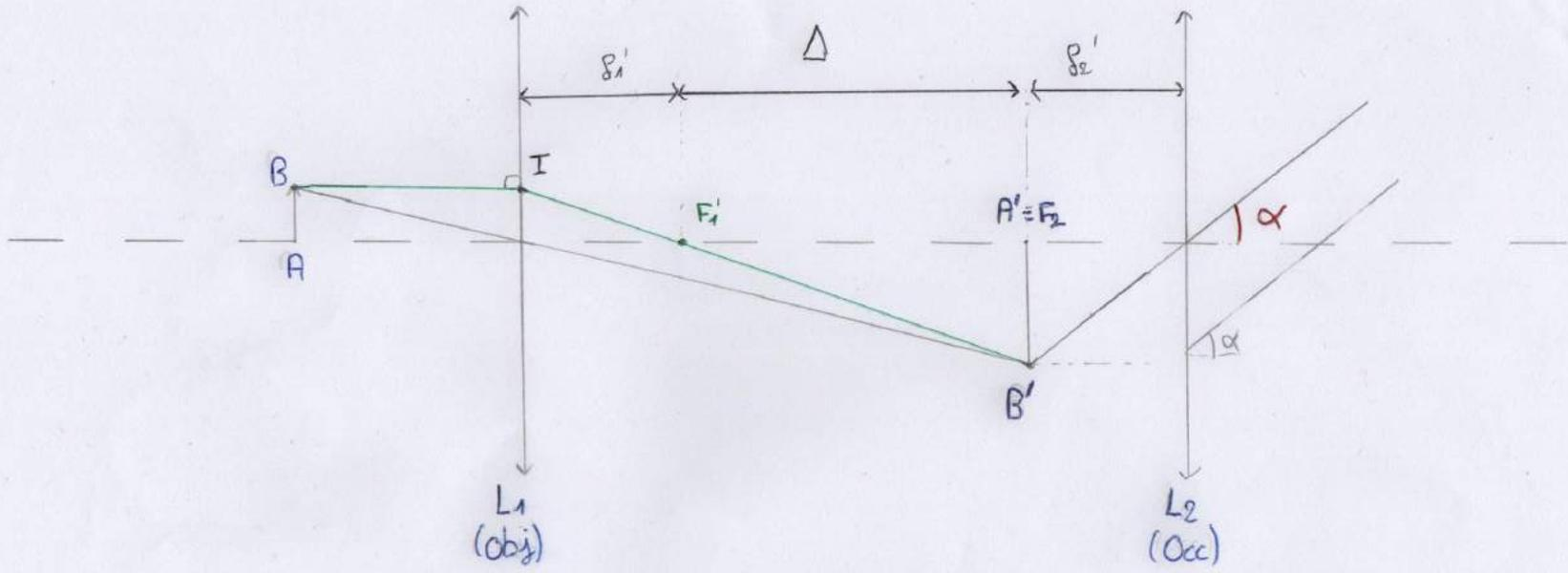
Schéma d'un microscope composé
