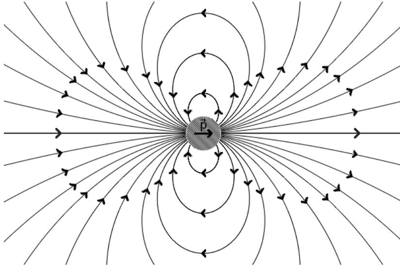
Figure 1 – Lignes de champ du rayon électriques d'un dipôle de moment  $\mathbf{P}$
