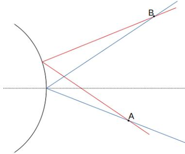
FIGURE 2 – chemin optique avec réflexion sur un miroir convexe
