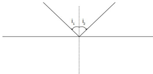
FIGURE 4 – réflexion d'un rayon lumineux lors du passage à un milieu d'indice  $n_0$  à  $n_1$
