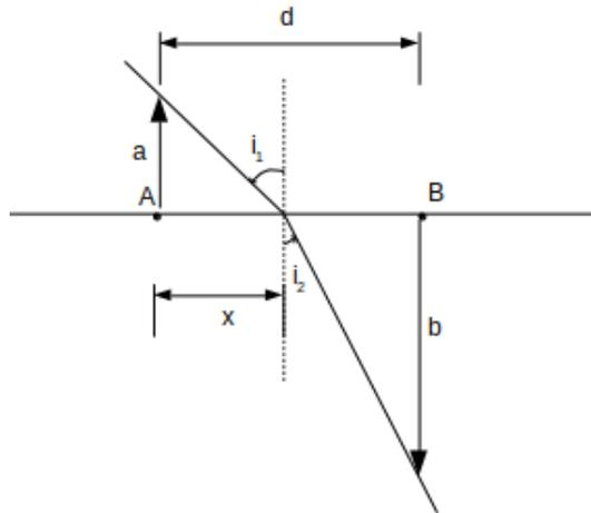
FIGURE 3 – réfraction d'un rayon lumineux lors du passage à un milieu d'indice  $n_0$  à  $n_1$
