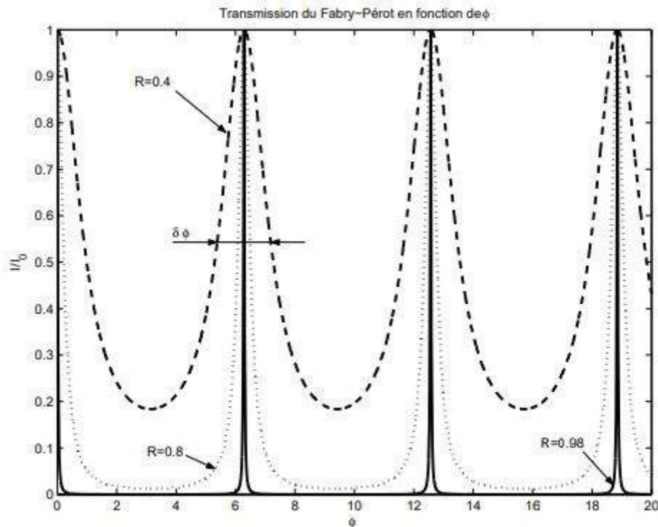
FIGURE 5.2 – Transmission d'un Fabry-Pérot en fonction de  $\varphi$ . Influence du coefficient de réflexion.
