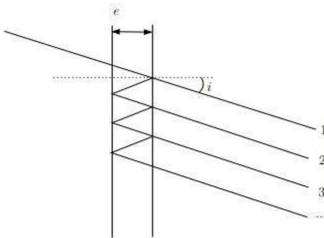
Pour simplifier notre étude on utilise un faisceau collimaté monochromatique et on place en sortie une lentille de focalisation pour observer les franges sur un écran.
