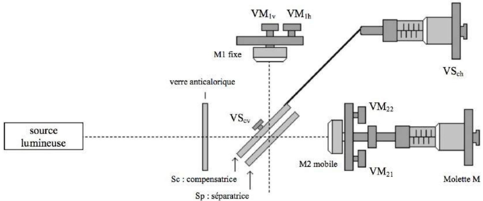
Fig 1 : L'interféromètre de Michelson
