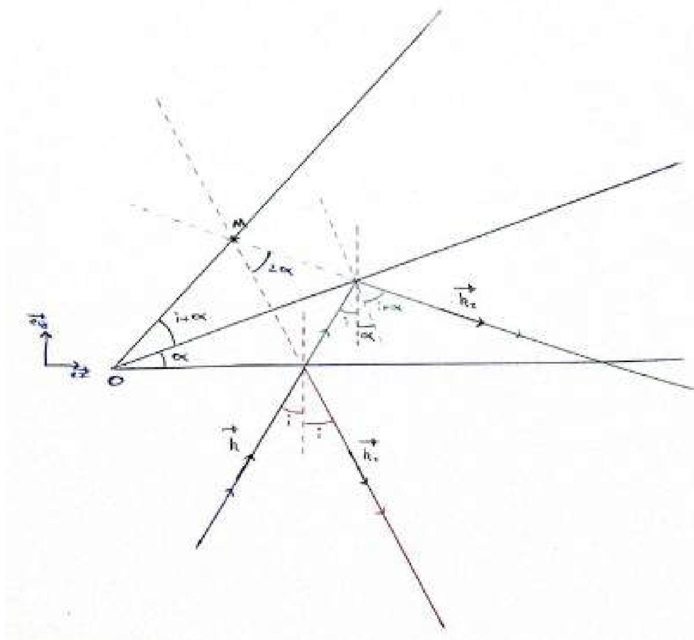
Fig 4 : Configuration en coin d'air de l'interféromètre.
