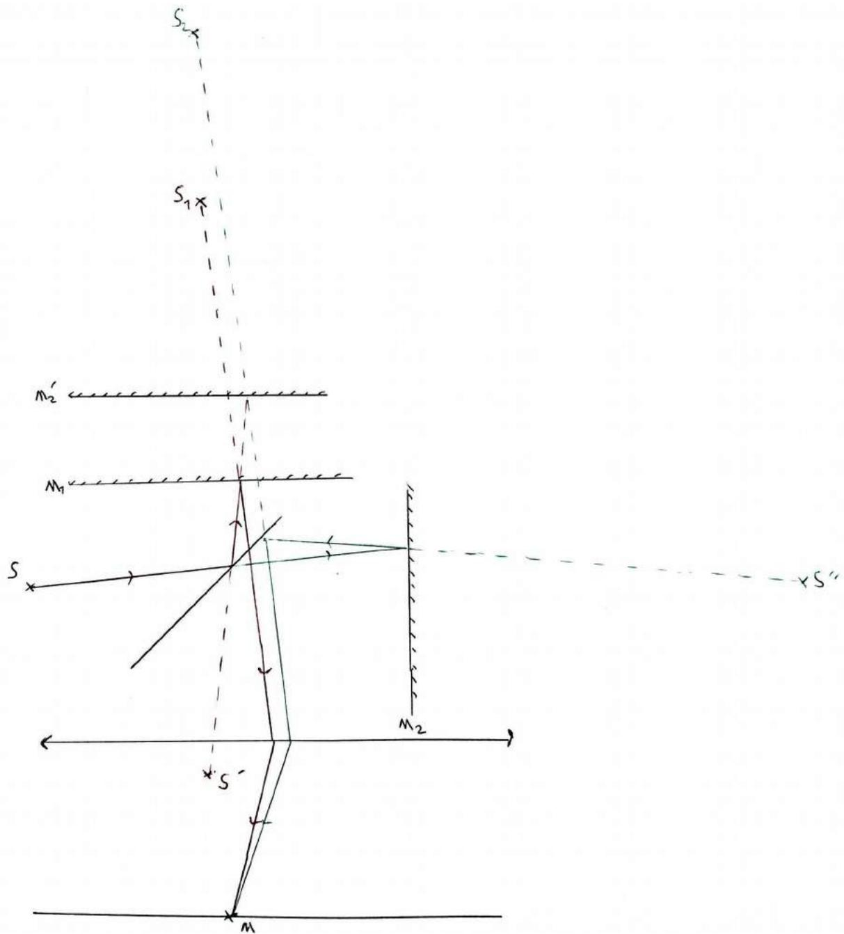
Fig 2 : Configuration en lame d'air de l'interféromètre
