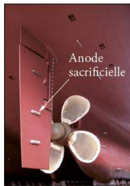
Image 5 – Anode sacrificielle de zinc sur une coque de bateau
